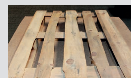
Unzulässiges, nicht dem Technischen Regelwerk der EPAL entsprechendes Bauteil, z. B. untermaßig, morsch, Baumkante
